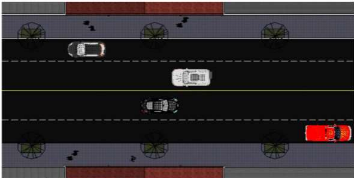
ESPAÇO ÁRVORE PARA CALÇADAS MAIORES DO QUE 2,5m DE LARGURA EM NOVOS LOTEAMENTOS
